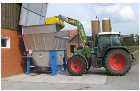
Dosierer Typ 200 mit 20 m³ Lagervolumen, Entnahmeschnecke Typ 160 und hydraulisch betätigtem Deckel
