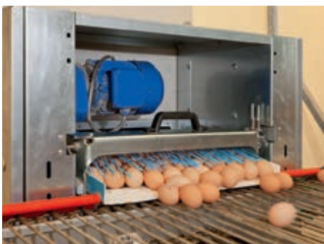
Pojačana pogonska jedinica trake za jaja
