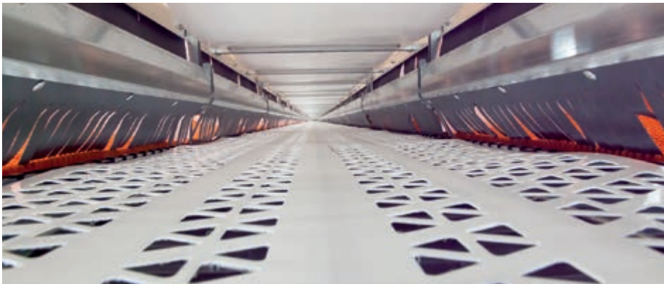
Središnji, 500 mm široka uzdužna traka za jaja s trokutastim otvorima za stabilnu poziciju jaja na traci
