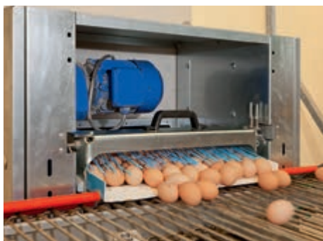
Wzmocniony napęd taśmy do zbioru jaj
