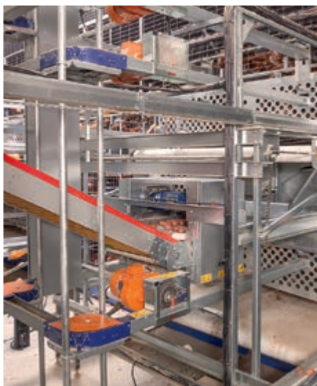
Zbiór jaj za pomocą przenośnika ukośnego z automatycznym zbiorem jaj z systemu za pomocą elewatora
