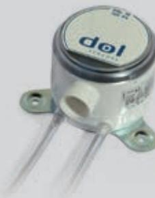
Avec DOL 18, nous disposons d'un capteur de pression négative qui mesure activement la pression dans le bâtiment. Le capteur fournit un signal de mesure de 0-10 V. L'alimentation en courant du capteur s'effectue par ViperTouch.
