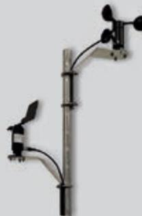
Метеостанция позволяет учитывать местные погодные условия при регулировании работы системы вентиляции. Она измеряет давление и скорость воздуха, а также определяет направление ветра.
