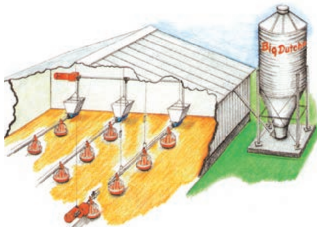
Schematische Darstellung eines Stalls mit AugerMatic-Linien
