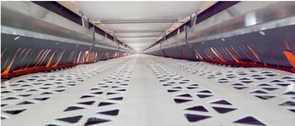
Nastro centrale, profondità 500 mm nastro uova longitudinale con fori triangolari che migliorano la stabilità delle uova
