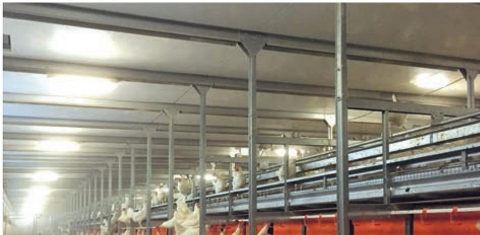
La superficie bianca e liscia dei pannelli di plastica lascia entrare l'aria fresca trasversalmente dentro il capannone senza ostacoli ed aumenta la luminosità ai piani inferiori
