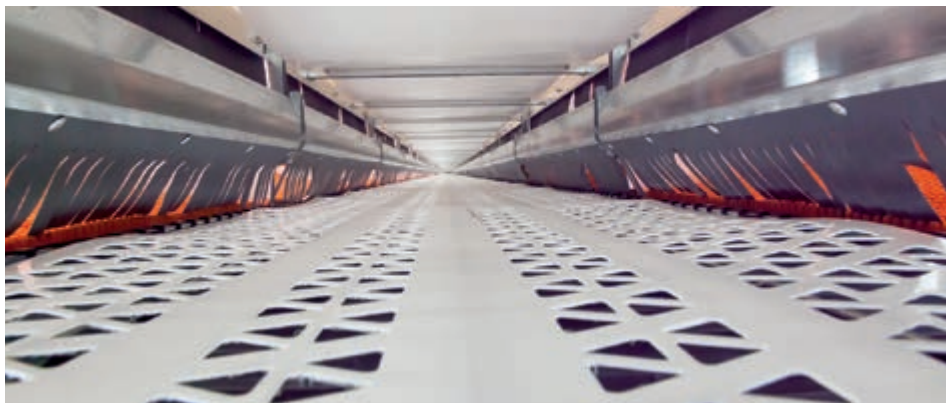
Centralna, 500 mm široka, uzdužna traka za jaja sa trouglastim rupama za stabilan položaj jaja
