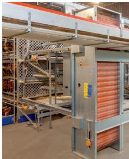
Збір яєць за допомогою вертикального конвеєра та автоматичний збір яйця за допомогою елеватора
