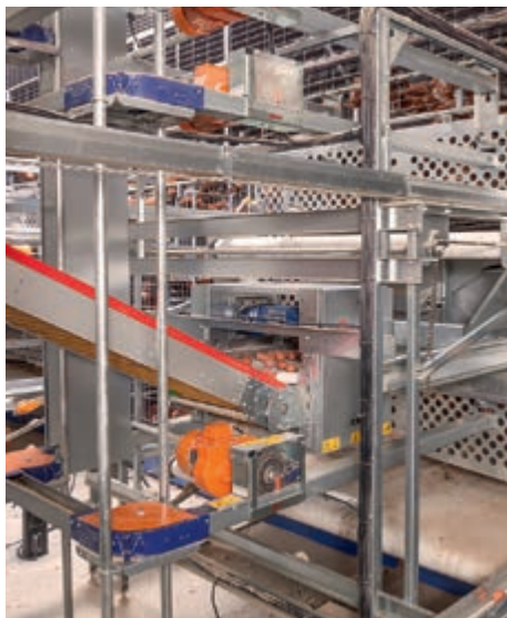
Збір яєць за допомогою вертикального конвеєра та автоматичний збір яйця за допомогою елеватора
