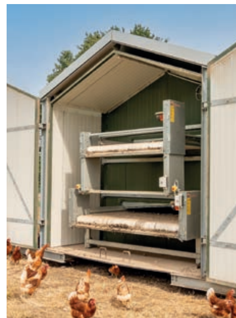
Система за автоматизирано изкарване на торовата маса
