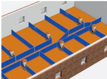
Ferkelaufzuchtabteil mit Stichgang und Futterautomaten, die in der Trennwand montiert sind
