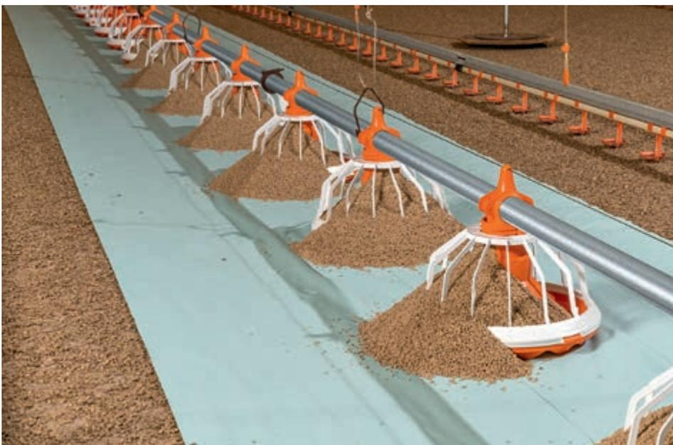
Für einen optimalen Kükenstart kann die speziell dafür entwickelte FLUXX 330 automatisch überflutet werden
