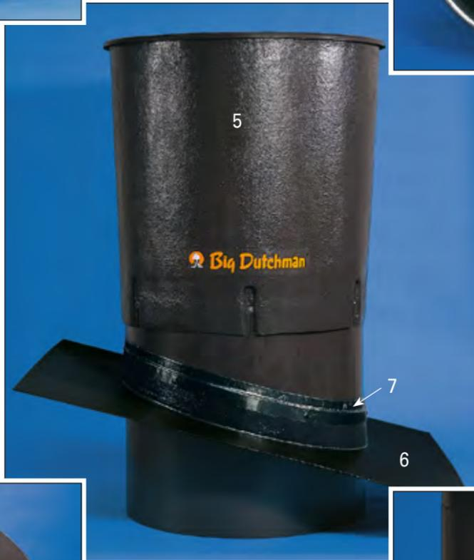
对于烟囱直径比较小 ( $\Phi$  35-71 厘米) 的，则可以使用 Belimo 伺服电机。使用排风出口 (5) 增加了通过烟囱的排风量 (文丘里效应)，也能减少进入烟囱的雨水。烟囱由弹性很好的屋顶瓦 (6) 和沥青处理带 (7) 来密封。屋顶瓦由坚固的玻璃钢制成，可根据屋顶坡度定做。
