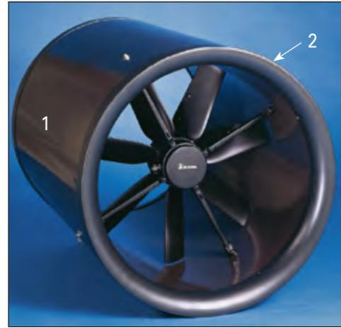
Big Dutchman® 排风管壁厚为 50 毫米的 PU 管 (1)，100% 不含氟氯化碳，有光滑的玻璃钢涂层。进风嘴 (2) 由聚乙烯制成，安装在烟囱的两端 (顶部和底部)，提高了空气动力性能。作为标准配置，烟囱由带 CL 74 伺服电机 (4) 的挡板 (3) 关闭。
