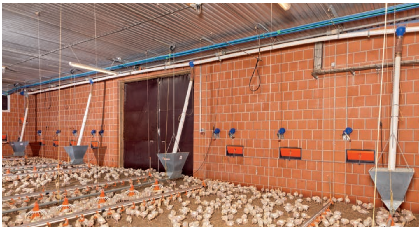
Ukázka použití navijáků pro nastavení optimální výšky napájecích linií v závislosti na stáří zvířat
