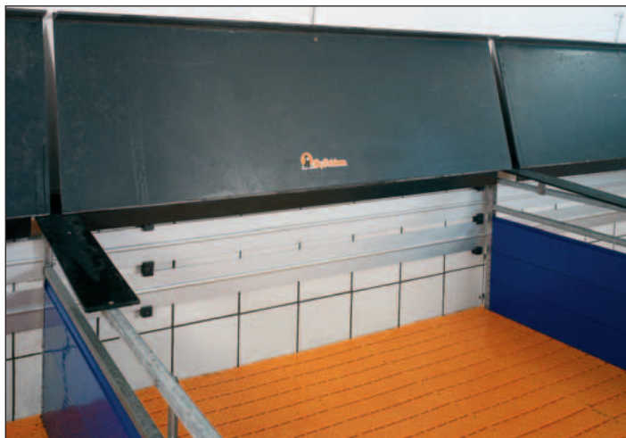
Pod krycou sklopnou doskou je plastový rošt s pomerom štrbín len 10 %, twinrúry v oblasti ležania
