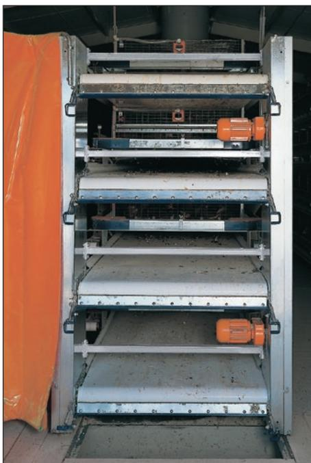
Bagian terakhir dari sistem pembersih dengan lubang penampungan kotoran.
