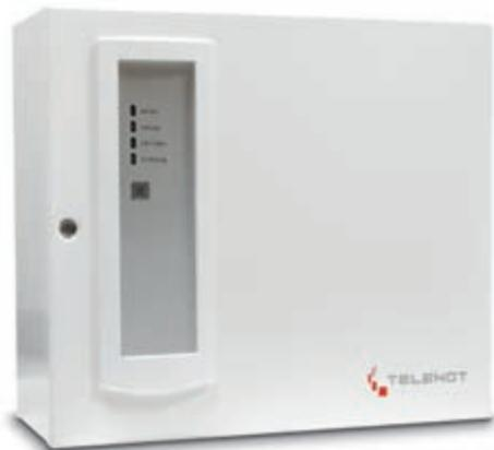
À l'aide de dispositifs d'alarme spéciaux il est possible de transférer les alarmes au téléphone ou au portable si l'administration ou les assurances exigent l'agrément du système d'alarme. Les deux appareils font partie de la prochaine génération utilisant une technologie IP. Ils disposent de 8 entrées pour identifier les différentes alarmes. La transmission soit par un câble ISDN, un câble Ethernet ou par ondes radioélectriques GSM.
