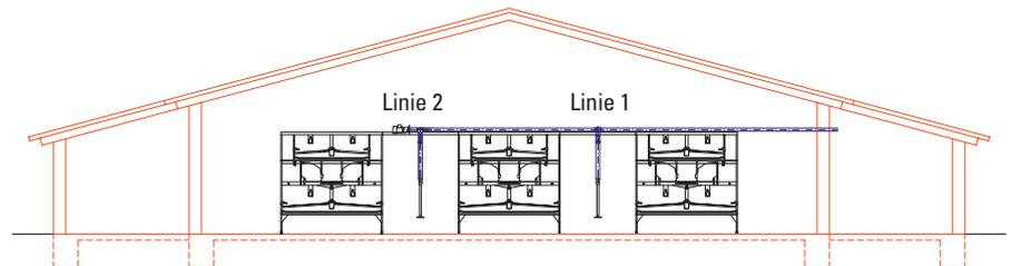
Stallquerschnitt: PickPuck mit automatischer Befüllung
