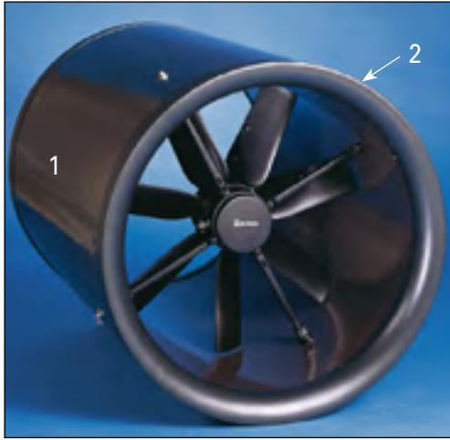
Big Dutchman® 排风管壁厚为 50 mm 的 PU 管 (1)，100% 不含氟氯化碳，有光滑的玻璃钢涂层。进风嘴 (2) 由聚乙烯制成，安装在烟囱的两端 (顶部和底部)，提高了空气动力性能。作为标准配置，烟囱由带 CL 74 伺服电机 (4) 的挡板 (3) 关闭。
