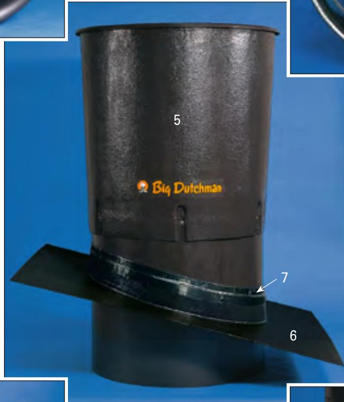
对于烟囱直径比较小 ( $\Phi$  35-71 cm) 的，则可以使用 Belimo 伺服电机。使用排风出口 (5) 增加了通过烟囱的排风量 (文丘里效应)，也能减少进入烟囱的雨水。烟囱由弹性很好的屋顶瓦 (6) 和沥青处理带 (7) 来密封。屋顶瓦由坚固的玻璃钢制成，可根据屋顶坡度定做。
