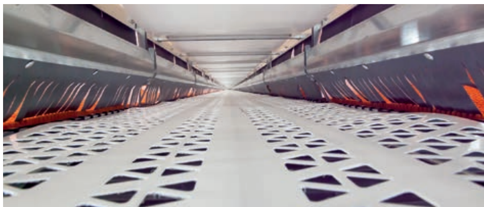
Централно разположена надлъжна лента с ширина 500 мм и специални триъгълни отвори за стабилно транспортиране на яйцата
