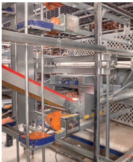
Събиране на яйцата с помощта на стръмен транспортър с вкл. автоматично събиране на яйца снесени в системата извън гнездото, и чрез елеватор
