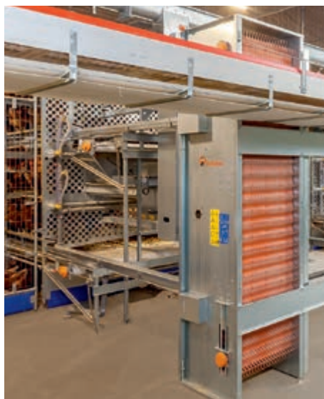
Събиране на яйцата с помощта на стръмен транспортър с вкл. автоматично събиране на яйца снесени в системата извън гнездото, и чрез елеватор
