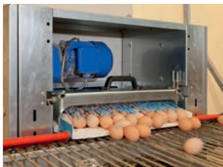
Подсилено задвижване на лентата за яйца
