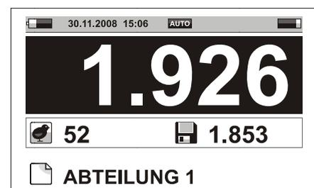
Das Speichersymbol blinkt auf dem Display, bis das Gewicht entfernt wird, und zeigt das zuletzt gespeicherte Gewicht auf dem Display neben dem Speichersymbol an.
