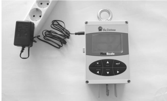
1. Stecken Sie das Kabel des Ladegerätes in die Waage
