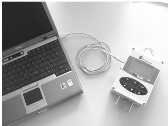
6. Windows wird ein neues Gerät *FlexScale Poultry Scale* erkennen und nach seinem Treiber fragen. Wählen Sie *Auf der CD suchen* aus, und schließen Sie die Treiberinstallation ab.
