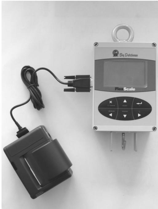
Stecken Sie das Druckerkabel in den seriellen Anschluss DB9 an der Waage, und schalten Sie den Drucker an.
