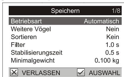
Nachdem der Vogel mit dem Haken an der Waage befestigt wurde, benötigt die Waage einige Sekunden, um sich zu stabilisieren. Der Vogel wird automatisch gewogen, und sein Gewicht wird in der aktiven Datei gespeichert.
