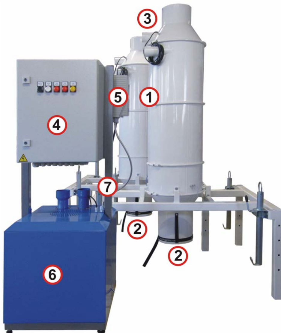
Bild 3-2: Halbautomatische Staubabsaugung mit zwei Abscheidern
