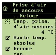
La prise d'air de secours a son propre réglage de température, **Température de prise d'air de secours**, qui est le nombre de degrés à ajouter à la **Température fixée** et éventuellement à la **Température confort**. Ce réglage vous permet d'ouvrir la prise d'air par temps chaud, quand le seuil d'alarme pour haute température normale ne suffit pas à déclencher la prise d'air.
