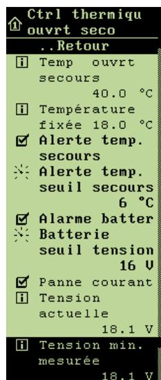
L'ouverture de secours à régulation thermique n'est déclenchée que quand la température intérieure excède le réglage de température de l'ouverture de secours (**Température d'ouverture de secours**). Vous pouvez voir le réglage sur l'affichage sous forme de valeur de température. L'ouverture de secours est aussi active en cas de panne de courant.
