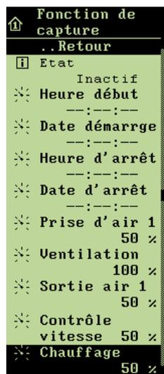
La fonction de capture est réglable au moyen d'une clé. Cette fonction ne peut alors être utilisée que sur activation de la clé. Si la fonction de capture est installée sans clé, elle démarre automatiquement à la date et à l'heure prévue. Dans les deux cas, la fonction de capture revient automatiquement sur **Inactive** dès que l'heure d'arrêt est passée.
