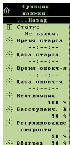
Ф-ция поимки может быть инсталлирована при помощи ключа, после чего ф-ция стартует в строках «Время старта» и «Время остановки».
