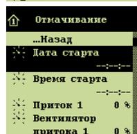
→ При помощи функции управления по времени, каждая из функций паузы может быть запущена в действие в заданный момент времени. Таким образом возможно задать всю последовательность работы функций паузы.
