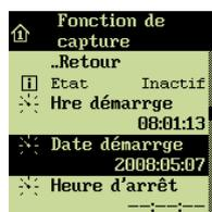
→ de tourner le bouton pour sélectionner **Date démarrage**, puis d'appuyer sur le bouton
