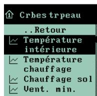
→ de tourner le bouton jusqu'à sélectionner le type de courbe voulu, puis d'appuyer sur le bouton
