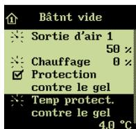
→ de tourner le bouton pour sélectionner **Température protection contre le gel**, puis d'appuyer sur le bouton
