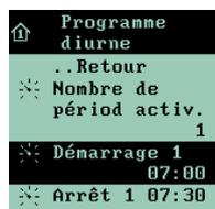
→ de tourner le bouton pour sélectionner **Démarrage**, puis d'appuyer sur le bouton
