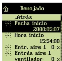
→ Mediante la función de control horario, cada función de pausa puede configurarse para que se inicie a una hora determinada. Así es posible configurar una secuencia total de funciones de pausa.
