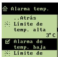
→ girar hasta que quede resaltada la línea **Alarma de temperatura baja**, y pulsar para conectar o desconectar
