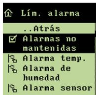
→ girar hasta que quede resaltada la línea **Alarmas no mantenidas**, y pulsar para conectar o desconectar
