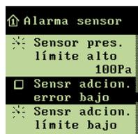
→ girar el botón hasta que quede resaltada la línea **Sensor error adicional bajo**, y pulsar para conectar o desconectar
