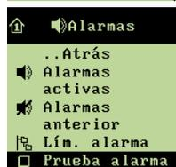
→ girar hasta que quede resaltada la línea **Prueba de alarma**, y pulsar para iniciar la prueba
