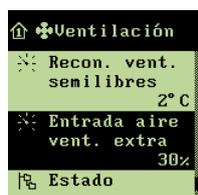
→ girar hasta que quede resaltada la línea **Entrada de aire de ventilación extra** y pulsar
