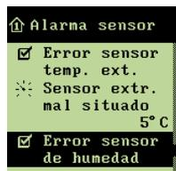
→ girar hasta que quede resaltada la línea **Error sensor de humedad**, y pulsar para conectar o desconectar
