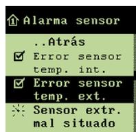
→ girar hasta que quede resaltada la línea **Error sensor temperatura exterior**, y pulsar para conectar o desconectar
