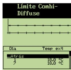
En la producción por lotes, la temperatura exterior puede configurarse como una curva con cuatro puntos, de modo que la apertura de las entradas vaya aumentando conforme suba la temperatura.
