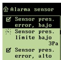
→ girar el botón hasta que quede resaltada la línea **Error sensor de presión bajo**, y pulsar para conectar o desconectar
