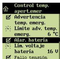
→ girar hasta que quede resaltada la línea **Alarma de batería**, y pulsar para conectar o desconectar
