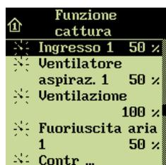
→ Ruotare per regolare un valore per ogni punto del menù
