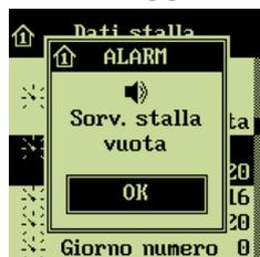
235Pro è dotato di protezione contro casi di impostazione scorretta di Stalla vuota. Quando lo stato del gruppo è stato modificato in Stalla vuota, il climacomputer effettua il monitoraggio della stalla per un'ora. Se la temperatura aumenta di più di 5° C in quest'arco di tempo (segno che ci sono animali nella stalla), 235Pro genera un allarme ed attiva tutti i sistemi di aerazione.
