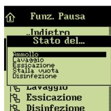
→ Ruotare fino ad evidenziare una delle funzioni e premere (**Amollo/Lavaggio/Essicazione/ Disinfezione/ Stalla vuota**)
