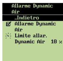
L'allarme Dynamic Air scatta in caso di errore meccanico. Il computer 235Pro fa scattare un allarme se la misura della potenza di ventilazione differisce dal fabbisogno di ventilazione calcolato.
