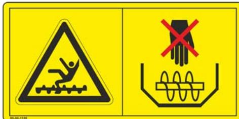
**Einzugsgefahr durch in Betrieb befindliche Schnecke, Kette oder Seilscheiben!**
