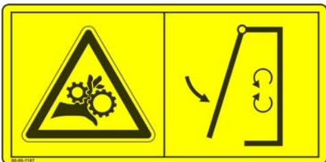
Cierre y asegure los dispositivos de protección antes de cada puesta en marcha de la instalación. Solo se permite abrir los dispositivos de protección con la instalación detenida y por parte de personas autorizadas para tal propósito.
