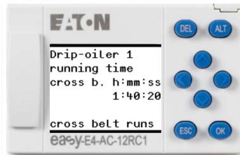
Ilustración 5-3: Tiempo de funcionamiento total del lubricador cuentagotas
