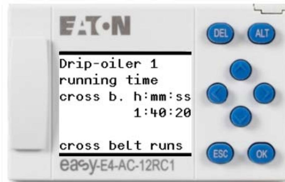
Figure 5-3 : Temps de fonctionnement total du graisseur compte-gouttes
