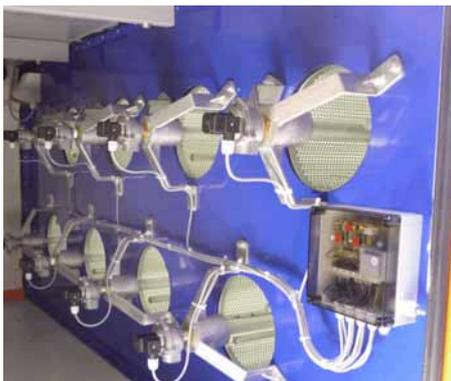
Die Filterpatronen werden kontinuierlich mit Staub beladen, so dass sie in bestimmten Abständen gereinigt werden müssen. Die Zeitintervalle hängen im Wesentlichen von der Staubkonzentration der Stallluft ab und können daher variieren. In der Regel sollte jedoch 2x am Tag für jeweils 10 Minuten gereinigt werden.
