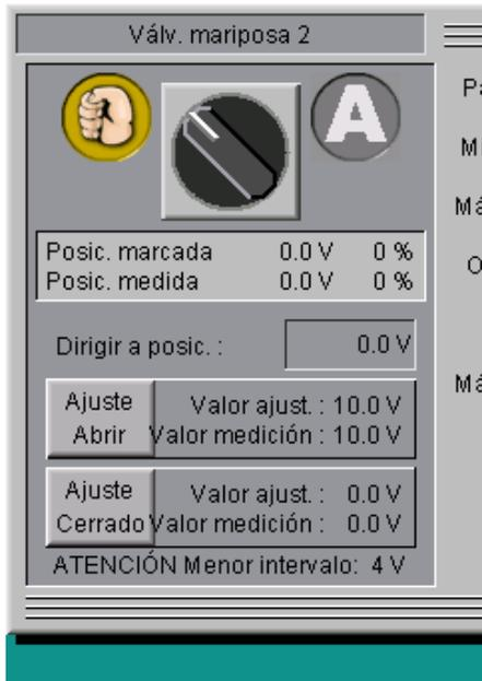
Ilustración 4-8: Válvula analógica con acuse de recibo
