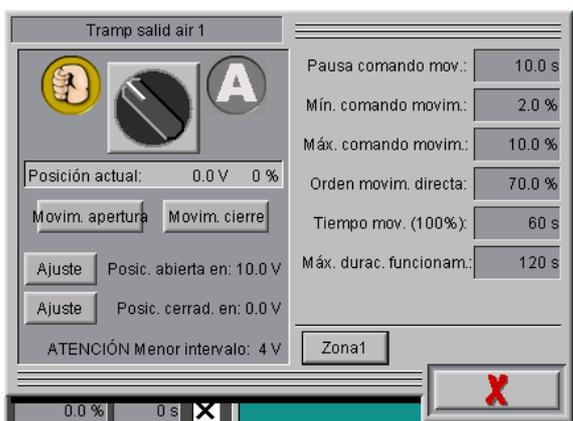
Ilustración 5-6: Válvula de salida de aire analógica con acuse de recibo
