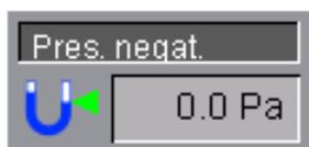
Aquí se indica la presión negativa medida actual. Si el aire de admisión (entrada) en la nave se controla por medio de una regulación de presión negativa activa, en la pantalla principal de la climatización se indica si está activado o si se encuentra en "modo seguro".
