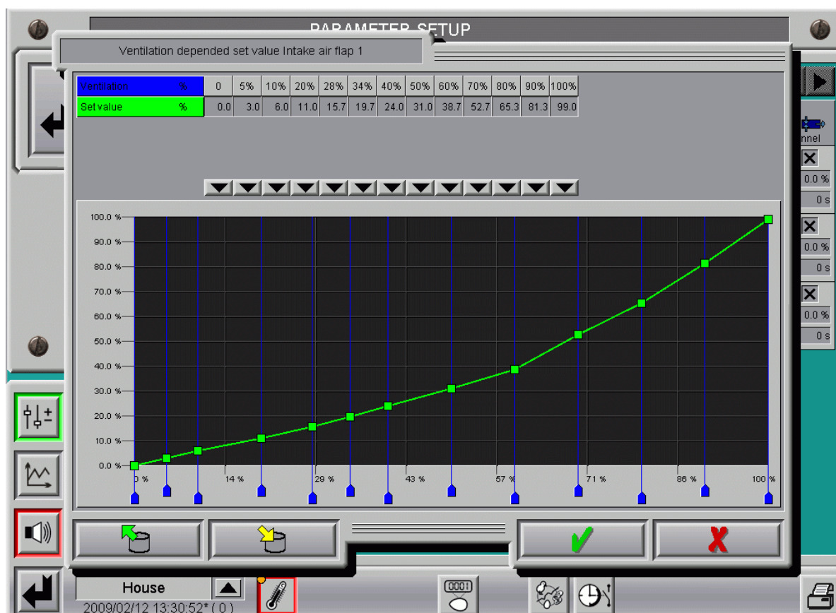
Figura 7-9: Curba caracteristică a ventilației raportate la valoarea de reglaj pentru admisia naturală a aerului
