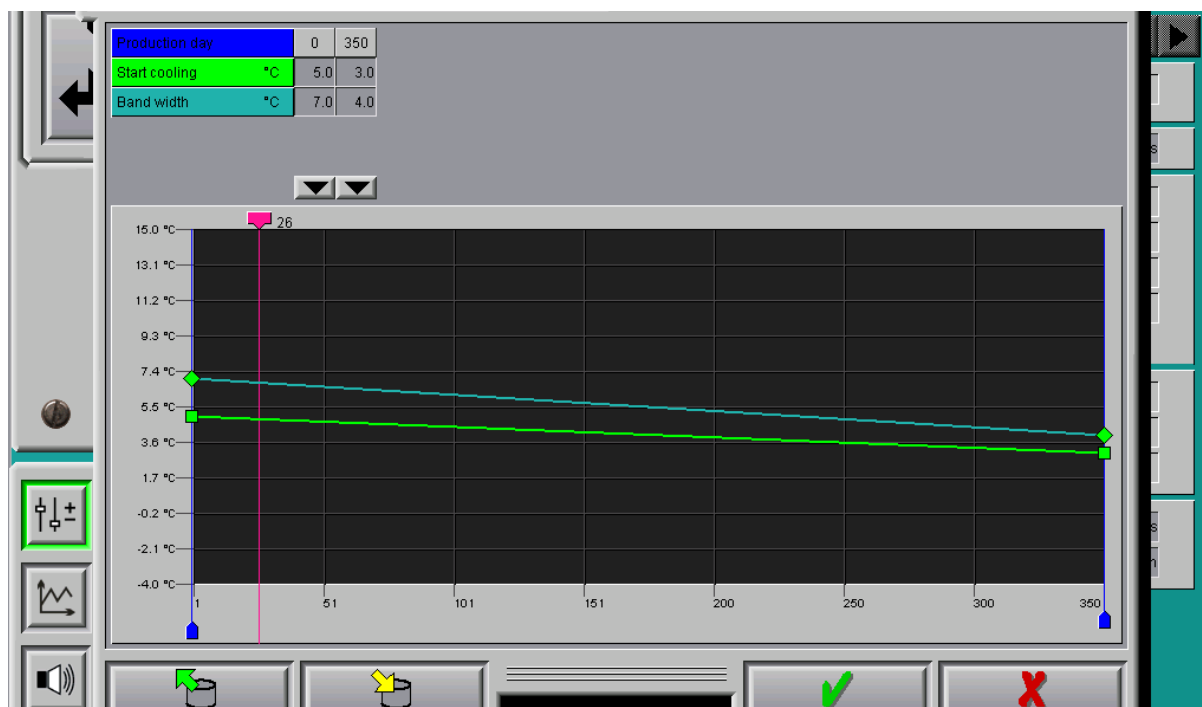
Figura 12-4: Curba pentru reglarea răcirii
