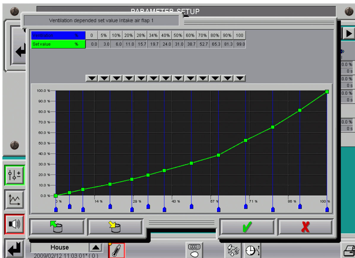
Figura 9-8: Curba caracteristică a ventilației raportate la admisia aerului
