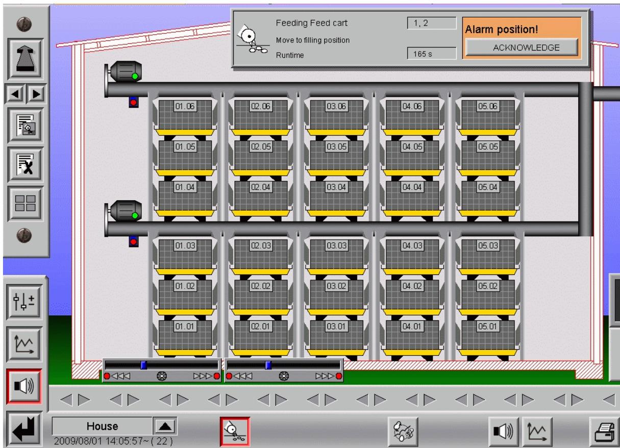
Ilustración 5-11: Error de posición carro alimentador
