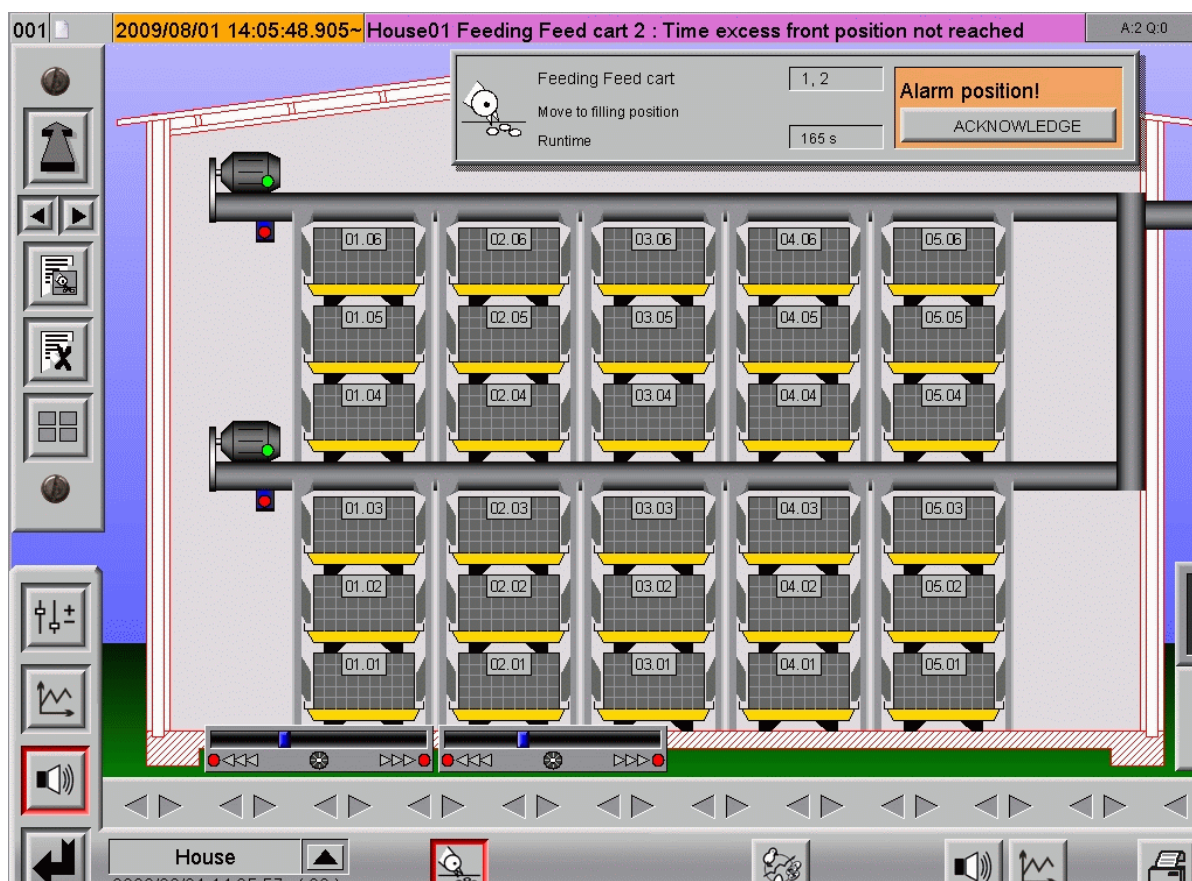
Slika 5-11: Napaka položaja vozička krme
