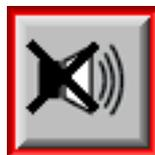
En cas d'alarme matériel, le relais d'alarme se déclenche et transmet l'erreur à l'avertisseur. Le symbole d'alarme rayé à gauche de l'écran est bordé de rouge. Si l'alarme ne peut pas être éliminée, le relais d'alarme doit être débloqué pour une nouvelle alarme. Vous pouvez appuyer sur le bouton à cet effet. Le relais d'alarme est à nouveau débloqué, la bordure rouge du bouton est masquée.
