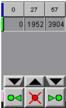
Pour supprimer un point d'appui, cliquez sur la flèche noire sous le point d'appui qui doit être supprimé. Sous la flèche, trois touches sont affichées. En cliquant sur la **X rouge**, le point d'appui est supprimé.
