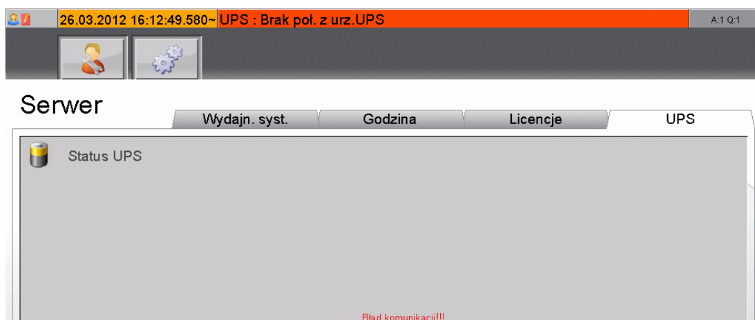
Rys. 4-25: UPS błąd komunikacji
