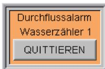
Bei einem Alarm wird im Hauptfeld ein Bedienfeld zum Quittieren des Alarms eingeblendet. Nach der Quittierung wird der Alarm zurückgesetzt und falls das Wasserventil geschlossen wurde, wird dieses wieder geöffnet.
