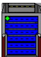
La temperatura del aire de entrada se regula mediante la compuerta de aire fresco y de aire de la nave. Si la temperatura es demasiado baja, la compuerta del aire exterior se cierra por un valor determinado y simultáneamente se abre la compuerta de aire de la nave por el mismo valor.
