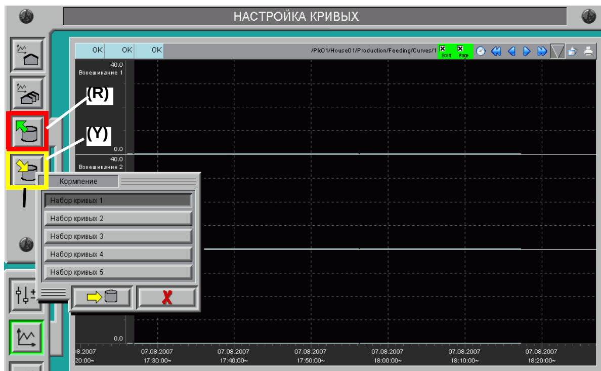
Рис. 6-3: Закачка конфигураций и фиксирование в банке памяти данных
