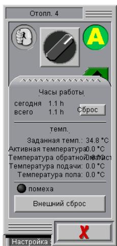
Индикация состояния отображает, включено ли отопление или находится в автоматическом или ручном режиме (мануальном). При нажатии экранной кнопки статуса открывается меню для ручного управления.
