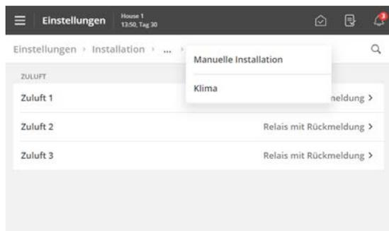
Bei einem 7-Zoll-Display können Sie durch Drücken der Menüüberschriften am oberen Rand des Displays schrittweise in den Menüs zurückgehen.
