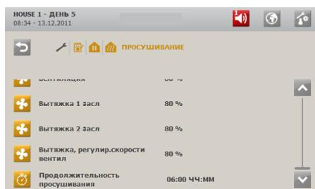
Просушивание - это сочетание вентиляции и подвода тепла. Чем больше тепла подается в помещение, тем быстрее оно просохнет.
