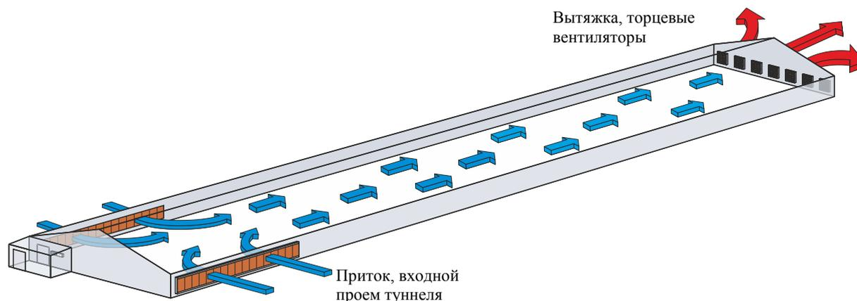
Рис. 1: Туннельная схема вентиляции
