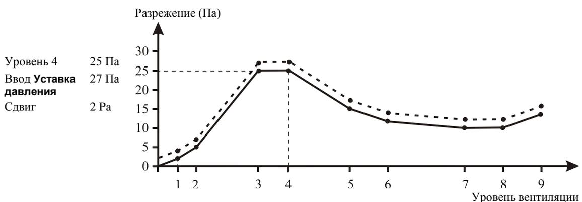
*Ввод **Уставки давления** сдвинет всю кривую давления параллельно количеству Па, которое изменит уставку по отношению к заданному давлению актуального уровня вентиляции до окончания откорма.*
