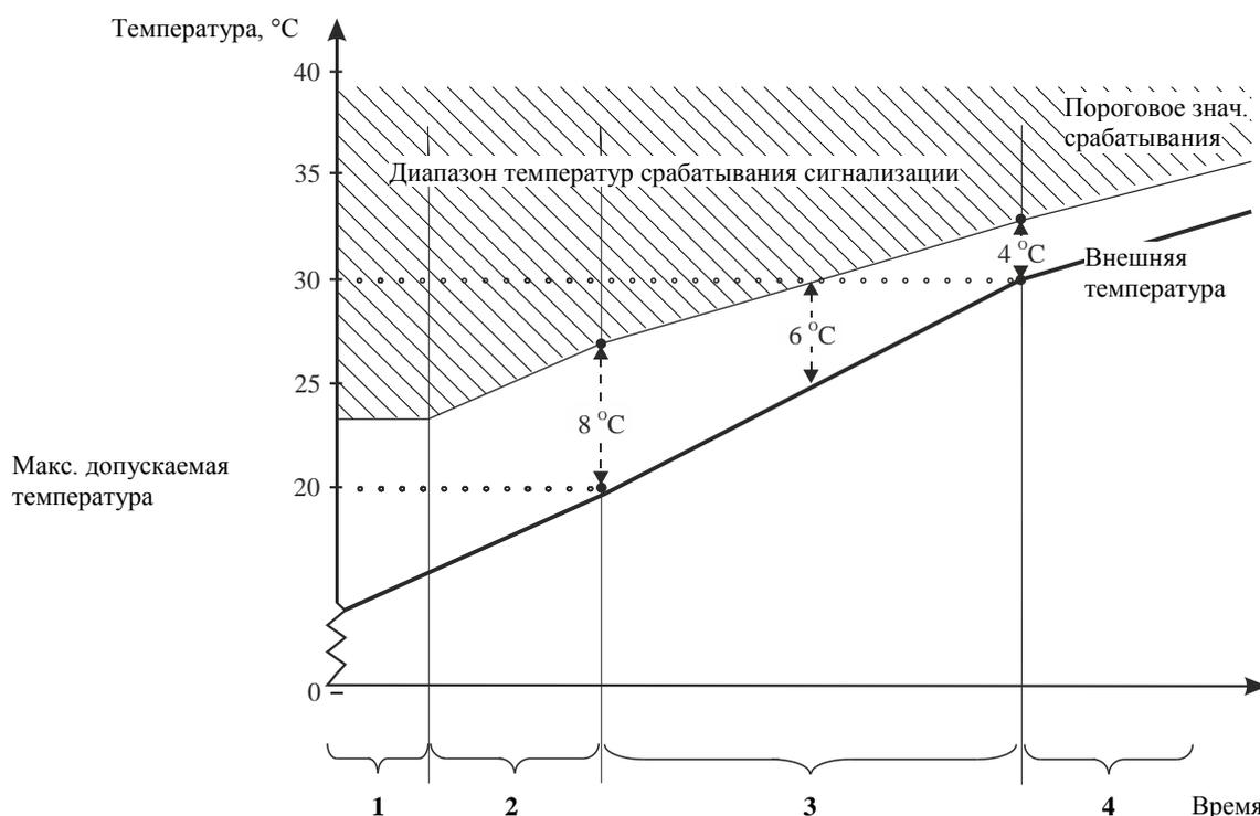
1. Пороговое значение высылки сигнала не опускается ниже **Макс. допускаемой температуры**.
