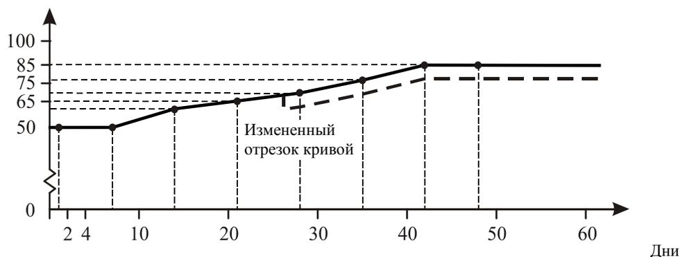
Вообще для всех функций, описываемых графиками, Viper Touch автоматически производит параллельное смещение остальной части графика, когда в настройки графика вносят изменения до истечения периода содержания партии.
