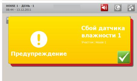
Пр срабатывании сигнализации контроллер микроклимата Viper Touch регистрирует тип события и время его возникновения.
