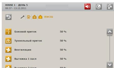
Эта функция обеспечивает воздухообмен в помещении, поддерживая вентиляцию на постоянном процентном уровне (50 %) мощности системы. Данная функция выступает как дополнительная мера предосторожности, на случай, если занятое помещение по ошибке получит статус **Пусто**.
