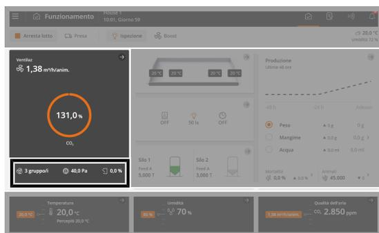
**Funzionamento.** I valori di ventilazione più importanti possono essere visualizzati e regolati tramite la scheda **Apparecchiatura climatica**.
