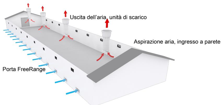
Figura 20: Ventilazione FreeRange in un sistema a pressione negativa
