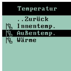
Die Außentemperatur gibt die aktuelle Temperatur außerhalb des Stallgebäudes an. Die Kurve für die Tendenz Außentemperatur gibt die Temperaturentwicklung außerhalb des Gebäudes während der letzten 24 Stunden wieder.
