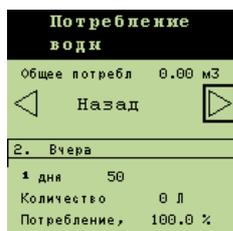
МС 135СТ регистрирует общий расход воды в литрах, предоставляя таким образом общий обзор расхода. В целях обеспечения выявления неожиданных изменений параметров расхода, расход воды параллельно отображается в процентах. В обычных условиях норма расхода поднимается на несколько процентов в день по мере увеличения возраста животных.
