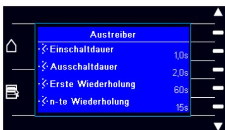
Tiere, die sich weigern die Tierwaage zu verlassen, können mit Hilfe von Luft aus dem Sorter getrieben werden. Dabei wird das Tier in bestimmten Intervallen mit Luft angesprüht. Nachdem die Wiegung abgeschlossen ist, erhält zunächst jedes Tier einen Luft-Impuls, damit es zügig den Sorter verlässt. Sollte ein Tier danach nicht innerhalb der "Zeit bis Austrieb" den Sorter verlassen haben, wird der Austreiber erneut aktiviert.
