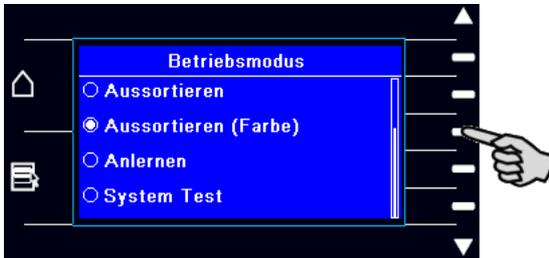
In diesem Modus werden alle Tiere aussortiert, die händisch mit Markierungsspray blau markiert wurden. Die Farbmarkierung wird in der Trisort durch einen Sensor erkannt.
