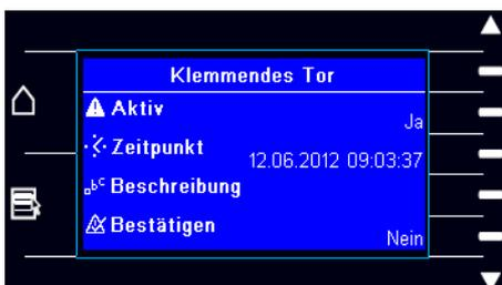
Neben "Zeitpunkt" werden das Datum und die Uhrzeit angezeigt, an der die Alarmmeldung aufgetreten ist.
