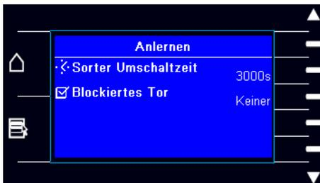
Der Anlernmodus dient dazu, die Tiere an die Station zu gewöhnen. Im Anlernmodus sind die Ein- und Ausgangstüren geöffnet und die Sortiertüren werden in bestimmten Zeitabständen aktiviert. Der Anlernmodus findet entweder innerhalb der Pausen statt oder der Sorter wird im Betriebsmodus "Anlernen" betrieben.
