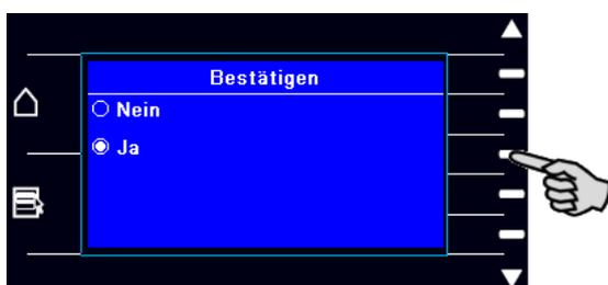
Drücken Sie die Taste neben "Ja" und anschließend die 'enter'-Taste, um den Alarm zu bestätigen.
