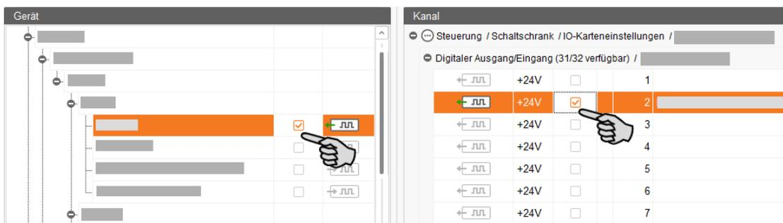
4. Schalten Sie das Gerät aus, indem Sie die Häkchen durch Anklicken entfernen.
