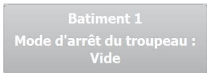
Une fois que le bâtiment est vide, CT2 Touch déconnecte la régulation de la climatisation et du contrôle selon les paramètres définis pour les fonctions de pause du bâtiment vide et le préchauffage. Cette mesure permet de protéger les animaux en cas d'erreur de bâtiment défini en tant que **Bâtiment vide**.
