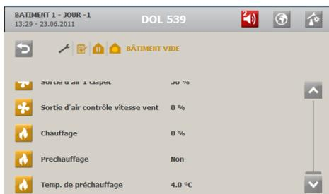
Le préchauffage assure que la température intérieure ne chute pas au-dessous de la température fixée pendant que l'état du troupeau est mis sur **Bâtiment vide** pendant un certain temps.
