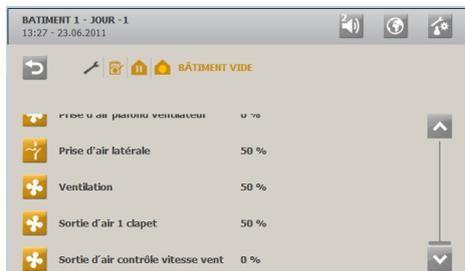
Cette fonction maintient la circulation de l'air dans le bâtiment tout en permettant à la ventilation de fonctionner à un pourcentage fixe (50%) de la capacité du système. Cette mesure permet de protéger les animaux si le bâtiment est paramétré par erreur en tant que **Bâtiment vide**.
