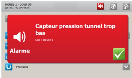
Lorsqu'une alarme est générée, CT2 Touch enregistre le type d'alarme et l'heure à laquelle elle s'est déclenchée.
