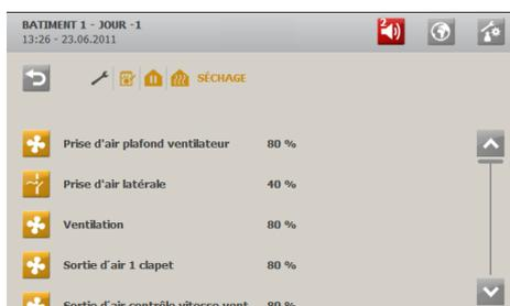
Le séchage est une combinaison de ventilation et de chauffage. Plus vous fournissez de chaleur au bâtiment, plus le séchage est rapide.
