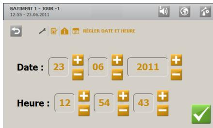
La correction de l'heure est importante pour plusieurs fonctions de contrôle et pour l'enregistrement des alarmes. L'horloge n'est pas désactivée en cas de panne de courant.
