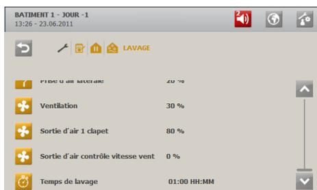
Pendant le lavage manuel du bâtiment, la ventilation doit fonctionner de nouveau pour démarrer le changement d'air dans le bâtiment.
