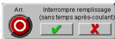
Le bouton pour arrêter le remplissage directement sans des temps d'après-coulant n'existe que sur la surface utilisateur (ordinateur de ferme et opération sur site).
