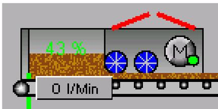
Si le clapet de service au-dessus de l'unité de dosage est indiqué en rouge, celui-ci est ouvert. L'interrupteur de sécurité a déclenché et les bandes sont arrêtées.
